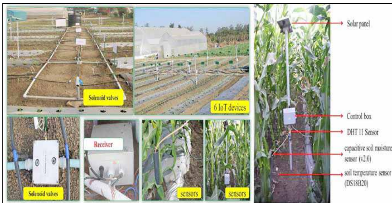
चित्र 2. आईओटी आधारित सिंचाई प्रणाली
