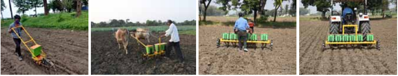
(अ) मैनुअल ड्रान (हाथ से खींचने वाली) (ब) बुलोक ड्रान (बैल चालित) (स) पावर टिलर ड्रान (द) ट्रैक्टर ड्रान
