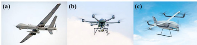
चित्र 3: ड्रोन प्लेटफॉर्म के प्रकार (अ) फिक्स्ड विंग ड्रोन, (ब) मल्टी रोटर ड्रोन, (स) हाइब्रिड ड्रोन
