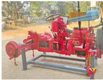
चित्र. सरकारी ट्रैक्टर कार्यशाला, कोयंबटूर में प्रशिक्षण उद्देश्य के लिए ट्रैक्टर कट सेक्शन मॉडल विकसित
