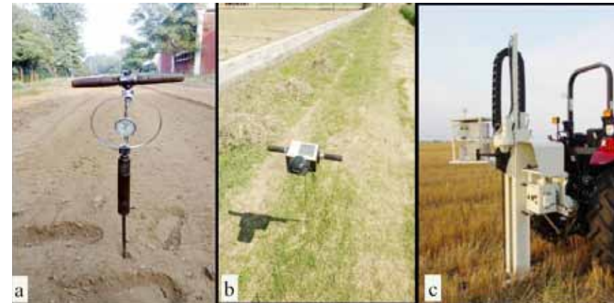
चित्र 5: पेनेट्रोमीटर प्रकार ए) रिंग प्रकार, बी) माइक्रो निर्यंत्रक प्रकार और सी) ट्रैक्टर संचालित मृदा शंकु पेनेट्रोमीटर
